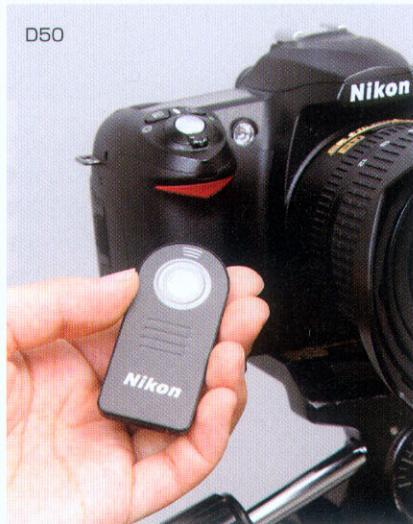
D70sでは、D70で要望の多かったリモートコードの取り付けが可能になった（写真左上）。オプションのリモートコードMC-DC1は、シャッター半押しやシャッターを押したままのロックができる。D50では、D70と同じように赤外線のワイヤレスリモコンML-L3で、外部からのコントロールができる（写真左下）。露光をマニュアルモード（M）にして、シャッタースピードをBlubに設定、さらにリモコンモードにすると、ボディ上面の液晶画面のシャッタースピードの表示が「--」となり（写真下）、リモコンのボタンを一度押すとシャッターが開き、さらにもう一度押すと閉じるというタイム撮影で、長時間露光できる。
