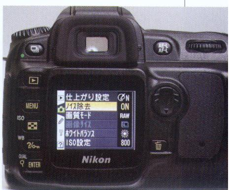
D50のメニュー画面は、文字も大きめで階層が深い項目もないで、わかりやすい。ノイズはきわめて少ない機種だが、ノイズリダクションの設定も可能だ。多くのデジタルカメラと同様に、長時間露出を行った場合、撮影直後に露出時間と同じ時間をかけてノイズ成分を取り除し、撮影画像からノイズ成分を差し引く処理を行うというものだ。
